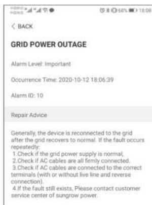
Figura 7-9 Informações detalhadas do alarme de falha
